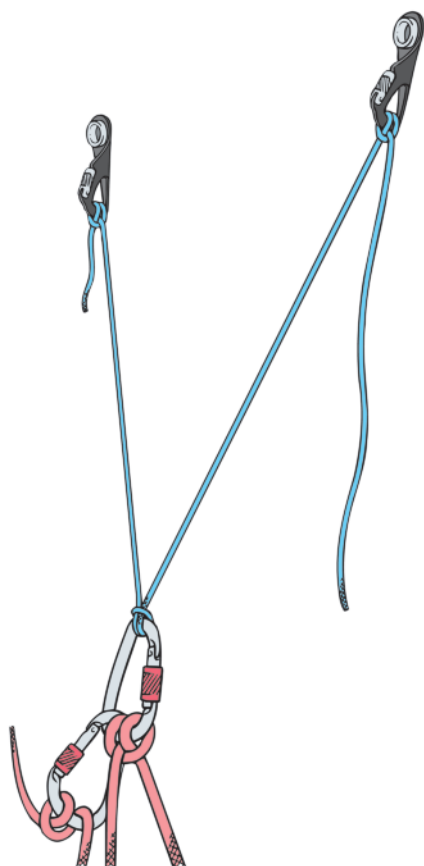
Abb. 1 Der Standplatz am Obstanser-Eisfall. Abb. 2 Das Unfallmaterial mit der gerissenen Aramid-Reepschnur vom Obstanser-Eisfall.
