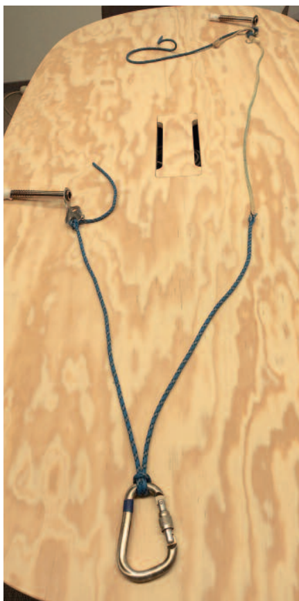
Abb. 1 Der Standplatz am Obstanser-Eisfall. Abb. 2 Das Unfallmaterial mit der gerissenen Aramid-Reepschnur vom Obstanser-Eisfall.
