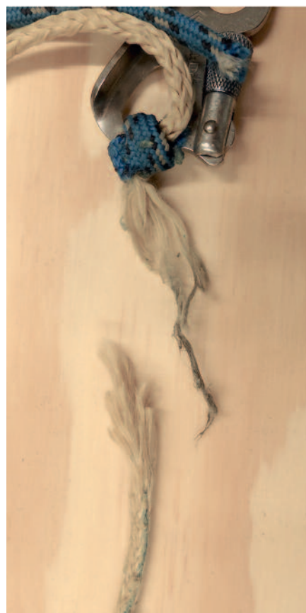
Abb. 1 Der Standplatz am Obstanser-Eisfall. Abb. 2 Das Unfallmaterial mit der gerissenen Aramid-Reepschnur vom Obstanser-Eisfall.
