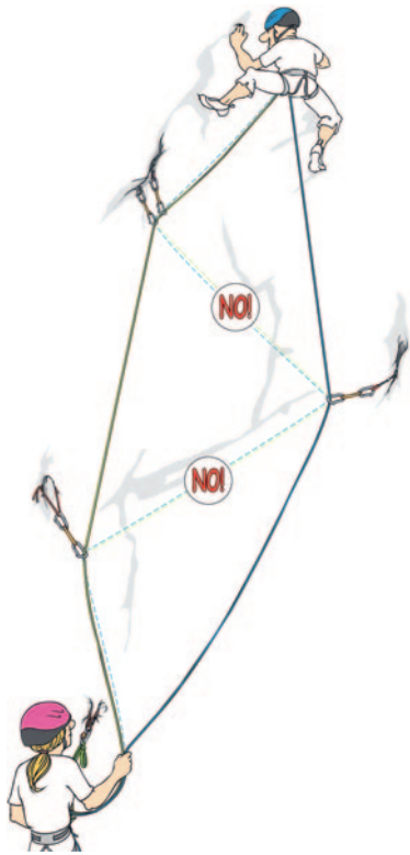
Abb. 5 Das wechselseitige Einhängen bei der Halbseiltechnik reduziert durch den geraden Seilverlauf die Seilreibung und somit die Belastung auf die Zwischensicherungen bei einem Sturz.
